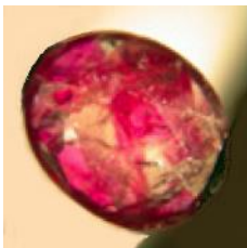
Corindón incoloro cuyas fracturas se han rellenado con un aceite rojo para simular un rubí. Se observa el color desigual siguiendo las fracturas.
