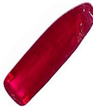
Corte longitudinal de una ampolla de rubí sintético Verneuil
