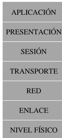
**Figura 6.11:** Capas del modelo OSI
