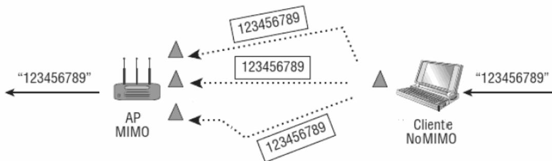
Figura 3.6: Recepción AP utilizando MRC
