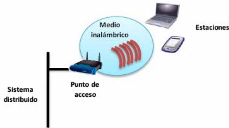
Figura 2.1: Componentes de una WLAN 802.11
