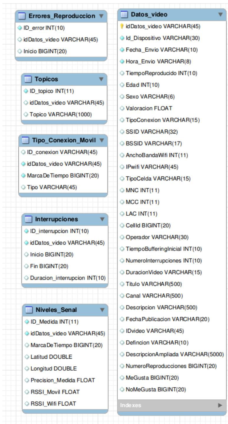
Figura 4.3.2: Diseño de las tablas de la base de datos
