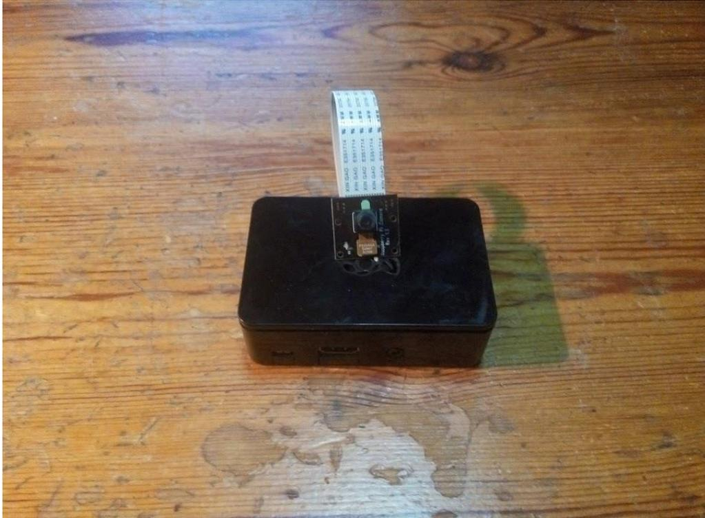
*Figura 7.4. Raspberry Pi con el módulo de cámara conectado*
