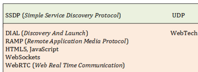
Figura 4.10: Pila de protocolo - Chromecast.
