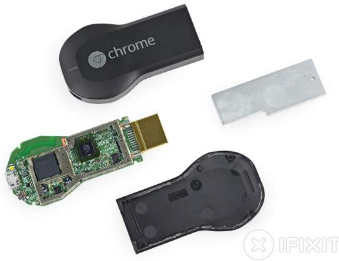
(a) Diferentes partes del dispositivo Chromecast.
