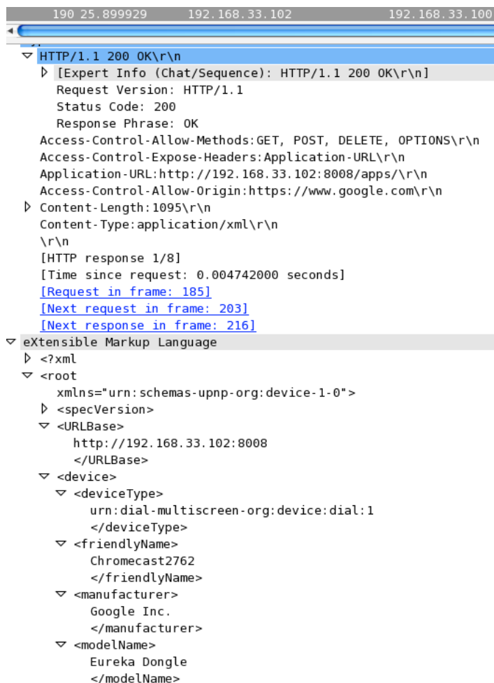
Figura 4.15: Información de la respuesta de descripción del dispositivo.
