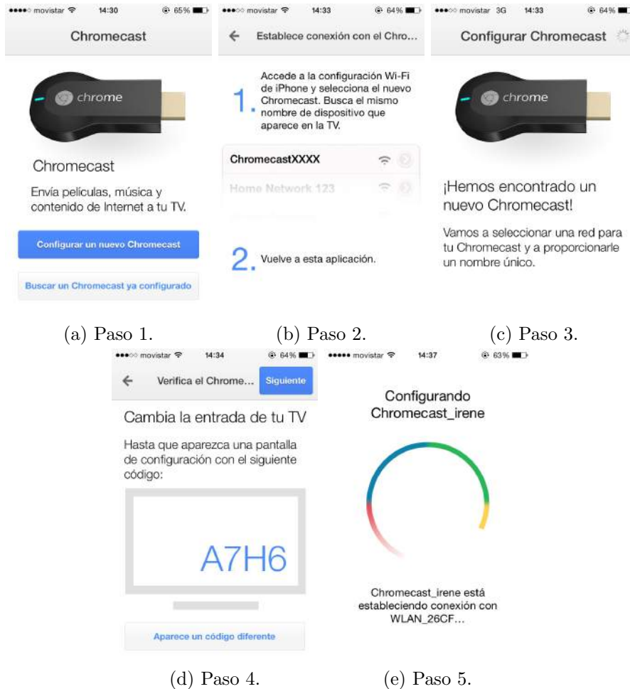
Figura 4.5: Configuración del Chromecast haciendo uso de la aplicación para iOS.
