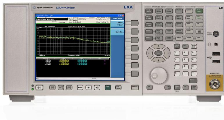
Figura 3.10: Analizador de espectros AGILENT EXA N9010A [10].
