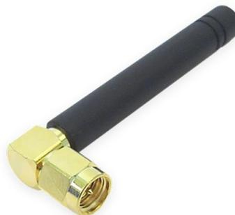
Figura 3.4: Antena Siretta Delta 1A.
