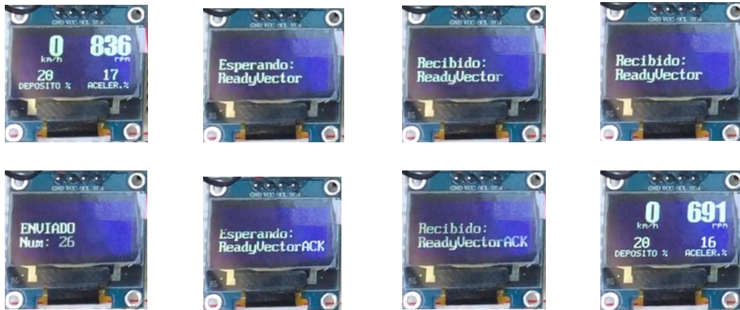
Figura 28. Visualización por el periférico OLED de los estados estacionarios.
