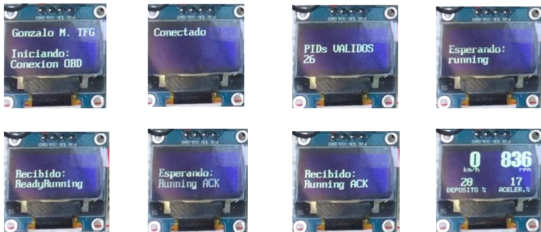
Figura 27. Visualización por el periférico OLED de los estados iniciales.
