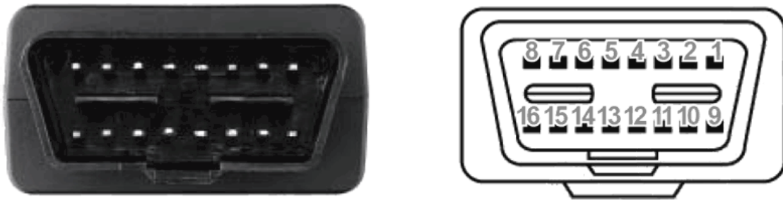
Figura 2. Vista del conector OBD de un dispositivo LnF CUMBUS y PinOut [2].
