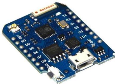
*Imagen 2. Microcontrolador ESP8266 Wemos D1 Mini Pro*
