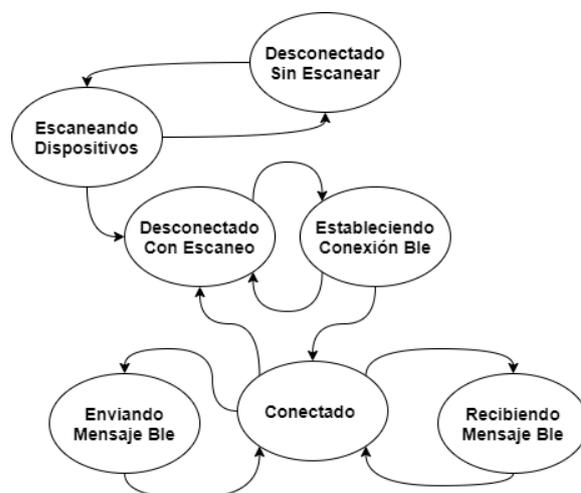
Figura 5.6: Diagrama de Estados del Paquete BLE
