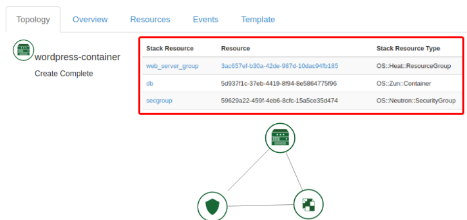
Figura 7.5: Pila de despliegue de Wordpress y MariaDB en dos contenedores.
