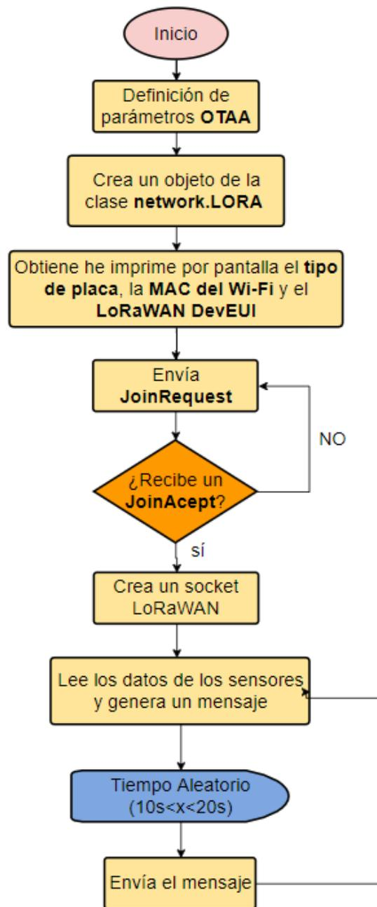
Figura 6.2: Diagrama de flujo del script ejecutado en la mota.
