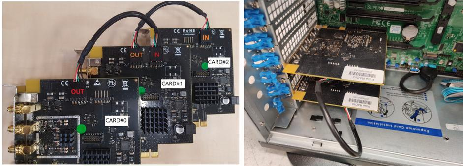
Figura 5.2: Conexión SDR50 en el servidor
