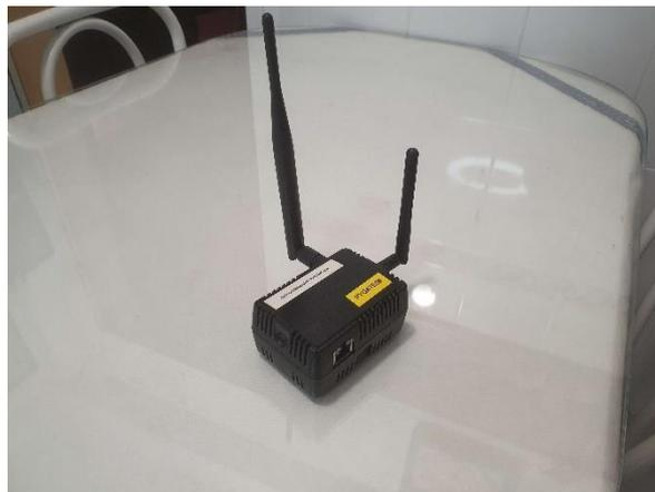
Figura 2.2: Pycom Pygate utilizada en el proyecto.
