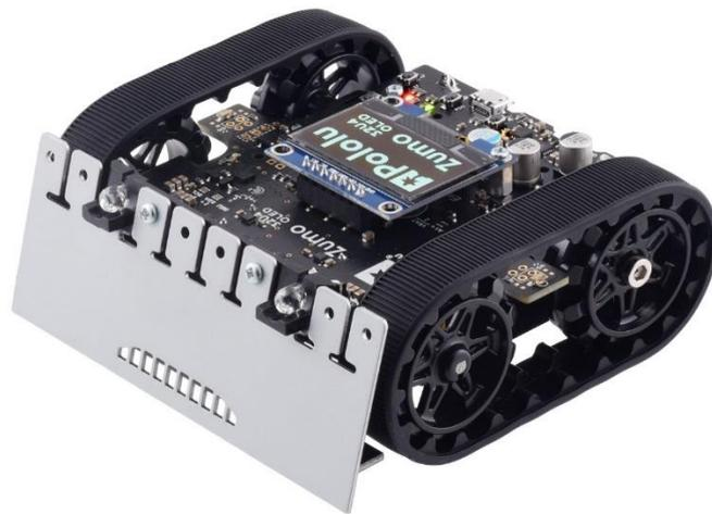
Figura 1.6: Robot Zumo de Pololu
