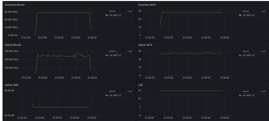
Figura 6.8: Experimentación srsRAN - ORAN-SC-RIC de referencia (Gráfica).
