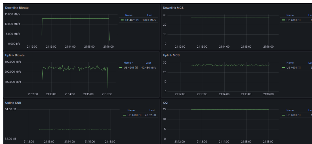
Figura 6.10: Experimentación srsRAN - ORAN-SC-RIC con ancho de banda reducido (Grafana).
