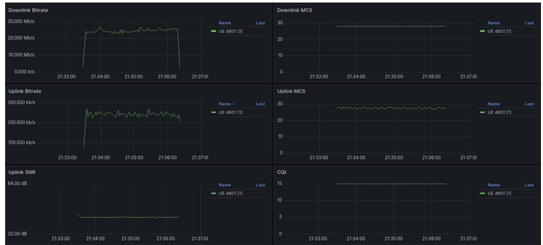
Figura 6.12: Experimentación srsRAN - ORAN-SC-RIC con ancho de banda reducido y aumento de la ganancia del UE (Grafana).
