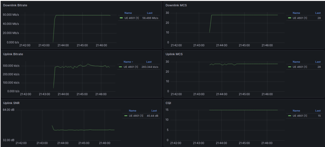
Figura 6.14: Experimentación srsRAN - ORAN-SC-RIC en banda n2 con aumento del ancho de banda (Grafana).
