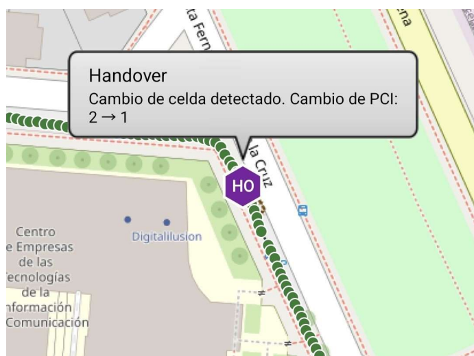
Figura 5.33: Marcador de handover generado tras detectarse un cambio de PCI de 2 a 1.
