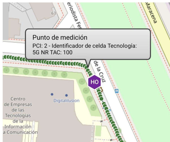
Figura 5.32: Representación de puntos de medida coloreados por PCI, mostrando una muestra asociada al PCI 2.
