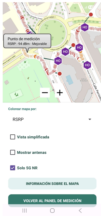
Figura 5.28: Representación de la trayectoria coloreada según el valor de RSRP medido durante la prueba.
