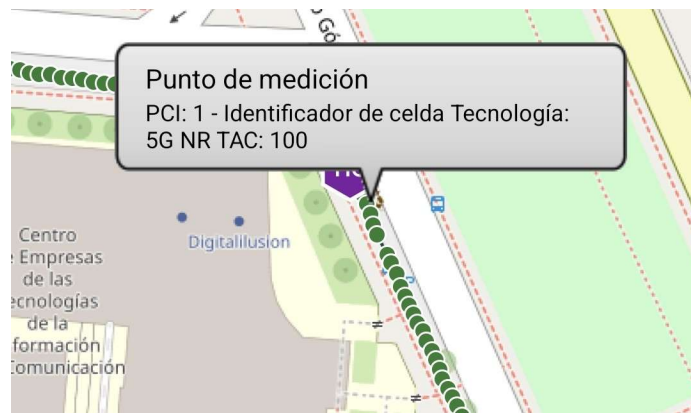
Figura 5.31: Representación de puntos de medida coloreados por PCI, mostrando una muestra asociada al PCI 1.
