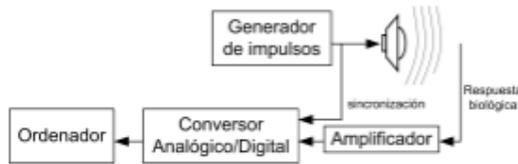
Fig. 2. Sistema de adquisición.
