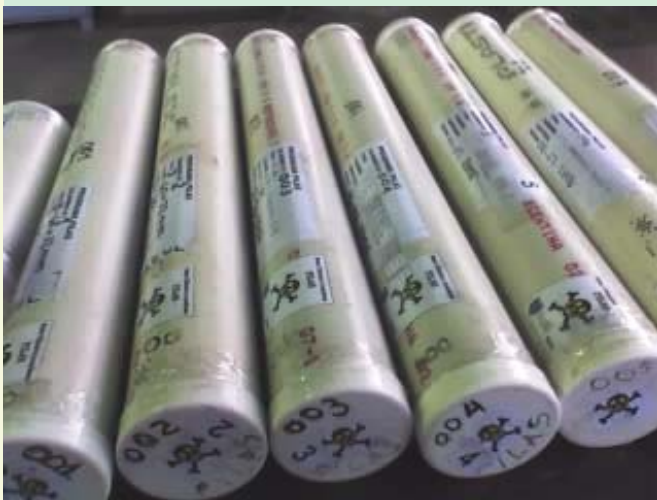
Figura 2: Tubos de PVC, con bentonita en su interior, para la disposición final de las pilas.
