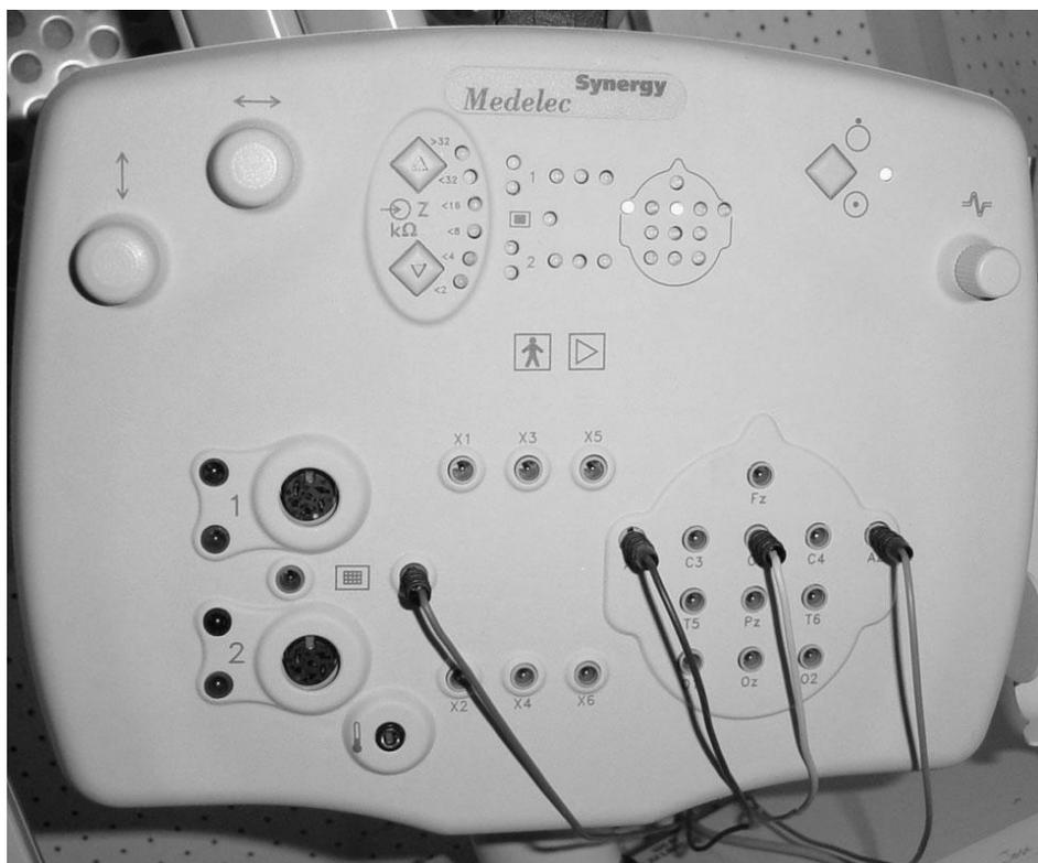
Figura 6.3: Preamplificador del equipo de potenciales evocados.
