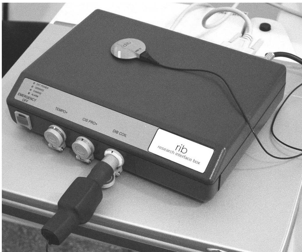
Figura 5.1: Unidad RIB (Research Interface Box) para conexión del equipo de estimulación y sincronización con el equipo de registro.
